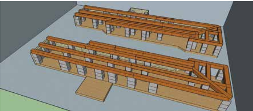
Fig. 25. Imatge de la reconstrucció en 3D en què podem veure el dibuix interior de les bigues que conformen la caixa harmònica. Font: elaboració pròpia.
